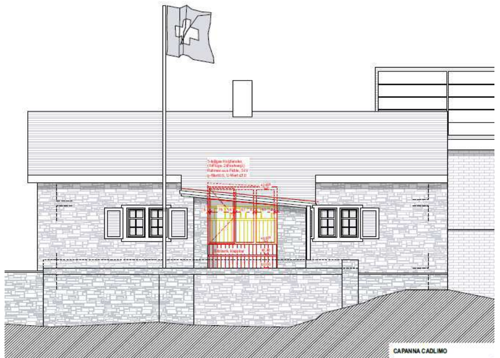
Neuer Notausgang und neue Fensterfront auf der Südseite
